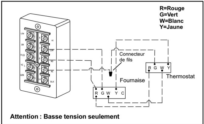
Figure 24. Synchronisation de la soufflante du VRC/HRV ou VRE/ERV avec la soufflante de la fournaise ou l'appareil de traitement de l'air
