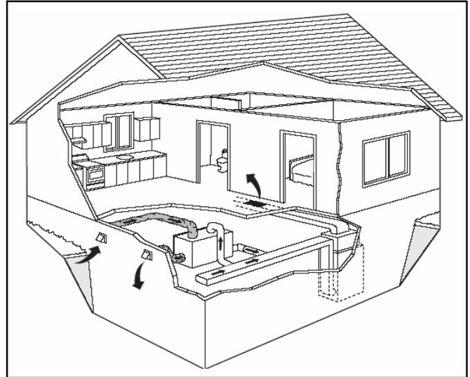
Figure 8. Installation simplifiée (reprise/reprise)
