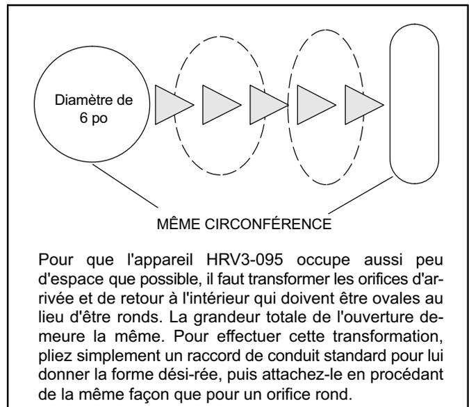
Figure 1. Façonner du conduit pour accommoder l'orifice ovale d'arrivée à l'intérieur
