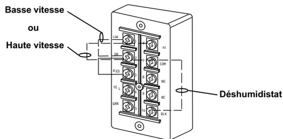
Figure 21. Addition d'une commande à con-
