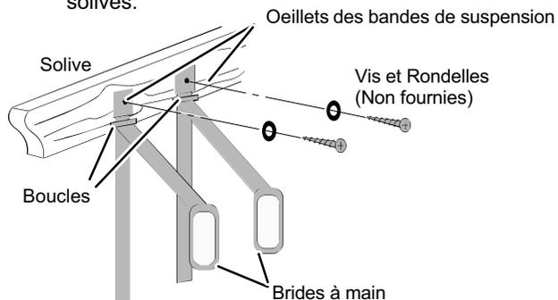
Step 3. Accrochez les oeillets en bas des bandes de suspension à travers les crochets "s". Tirez verticalement sur les brides à main en même temps que vous levez la partie inférieure de l'appareil. Répétez au côté opposé de l'appareil.
