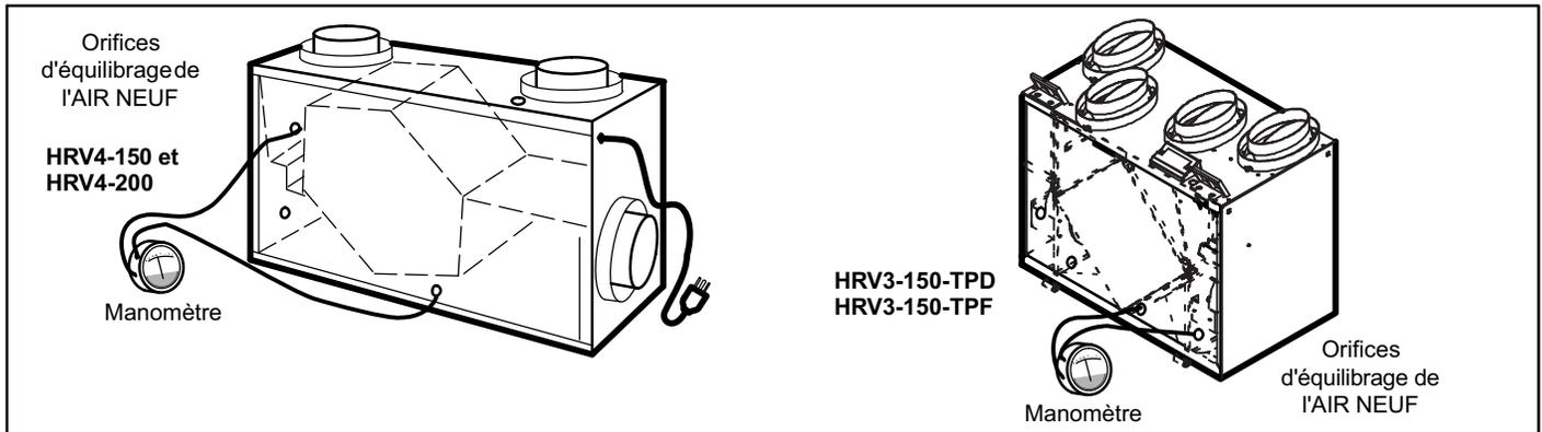
Figure 31. Mesurage de l'air neuf
