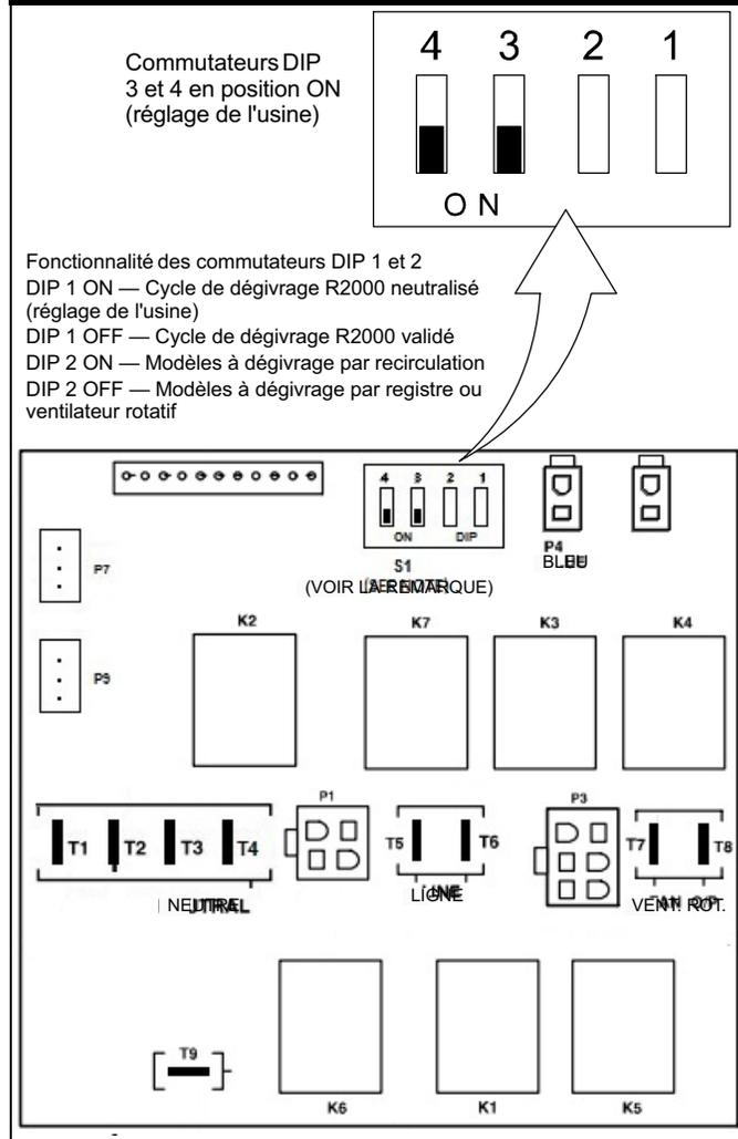
Figure 28. Réglages pour les vitesses
