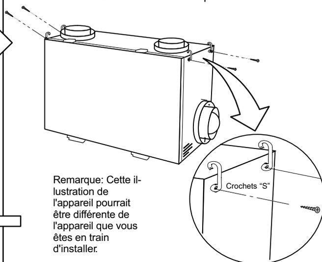
Step 4. Nivelez l'appareil par la gauche à la droite et par du devant à l'arrière.
